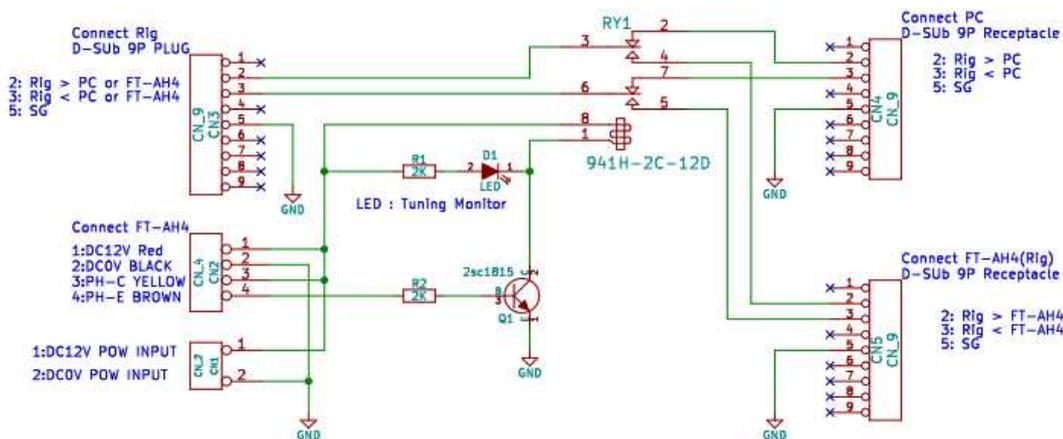
FT-LDGからのチューニング実行時の外部制御出力でリレーによりリグの通信先を切り替えます。
