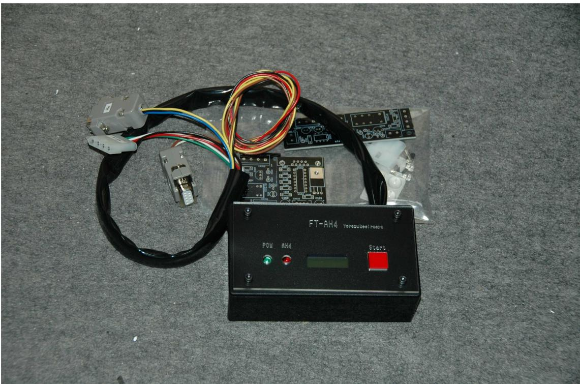
FT-LDGはFT-AH4をLDG社製のオートチューナーに対応させたコントローラーになります。写真等「FT-AH4」の物を流用しています。
