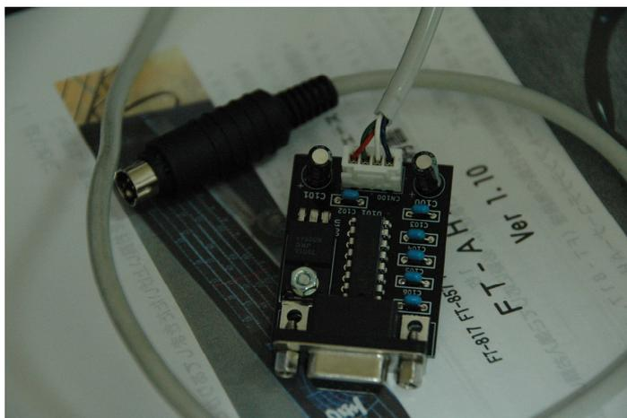
I COMのC I - Vに対応する場合はD 1 0 0を実装してS P 1を短絡してください。
