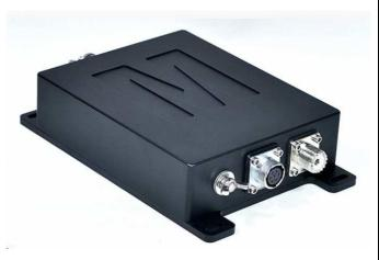
mAT-40 HF-SSB 自動アンテナ チューナーを使用すると、アンバランスまたは単線のアンテナを自動的にすば やく調整できます。ICOM、YAESU、KENWOOD など、さまざまなインターフェースケーブルを選択することで、自社ブランドのチューナーと同様に、さまざまなブランドの送信機で操作できます。チューナー ハウジングは、アルミニウム フライス加工と酸化表面技術によって製造され、美しく、繊細で、コンパクトでしっかりしています。あらゆる種類の過酷な屋外環境でうまく機能します。チューナーの最大サイズはわずか 20 cm で、現在の屋外用アンテナ チューナーでは最小です。
